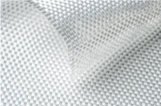
Ткани и ленты ровинговые «КОМПОТЕКС» произведены способом полотняного переплетения ровингов-жгутов, состоящих из нескрученных между собой стеклянных волокон. Благодаря распределению ровингов в процессе переплетения под углом 90° достигается равномерность распределения физических нагрузок и высокие показатели физико-химических свойств ткани.
